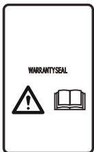
Šasija sadrži dijelove koji su osjetljivi na elektrostatička pražnjenja (ESP). Šasiju također treba profesionalno ponovno zabrtviti. Stoga šasiju smiju otvarati samo ovlašteni servisni tehničari. Zbog oštećene brtve cijelo jamstvo ili dijelovi jamstva mogu biti nevažeći.
